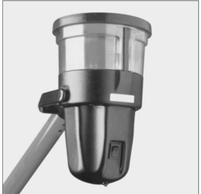
Das netzunabhängige Wärmemelder-Prüfgerät TDT 453 eignet sich zur Prüfung der Wärmemelder aus den Melderserien 130, 140, 150 und SecuriStar®. Es ist mit den Pflückerstangen des Securiton-Prüf- und Tauschgeräte-Programms kompatibel.
