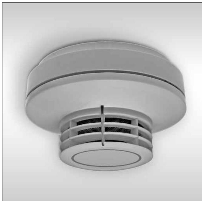
El detector de temperatura universal SecuriStar® TCD 563 se emplea cuando no se puede usar un detector de humo debido a las condiciones ambientales. El TCD 563 está diseñado para ser conectado a paneles de control convencionales que evalúan un incremento en la corriente.
