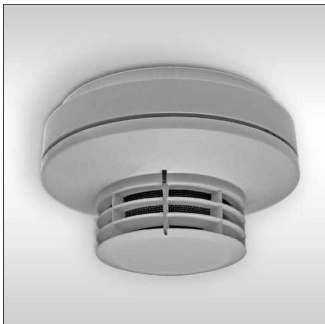
El detector de humo por luz dispersa SecuriStar® SCD 563 con procesamiento digital de señales y lógica de evaluación inteligente tiene un excelente comportamiento de respuesta y un índice muy bajo de falsas alarmas. El comportamiento de respuesta se adapta automáticamente a las temperaturas ambientales prevalentes. El SCD 563 está diseñado para ser conectado a los paneles de control convencionales que evalúan un incremento en la corriente.
