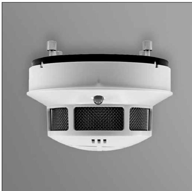
Durch den Einsatz des optischen Rauchschalters ORS 142 K wird Rauch in Lüftungskanälen frühzeitig detektiert. Durch das rechtzeitige Erkennen wird die Ausbreitung von Brandrauch durch die Lüftungsanlage verhindert und ein wirksamer Schutz sichergestellt.
