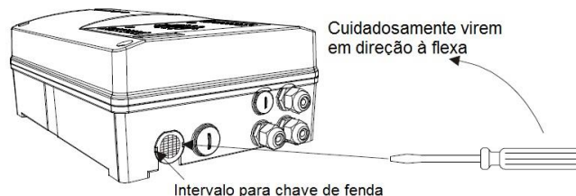
Fig.4 Remoção do plugue de tubo de saída de ar
